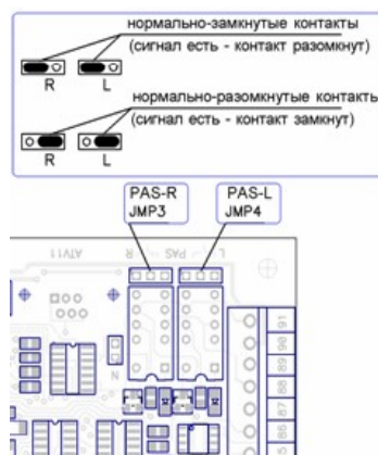
Рисунок 91. Перемычки JMP3 и JMP4 контроллера ОМА–DD.958, ОМА 264MC1, 866.MC2.
