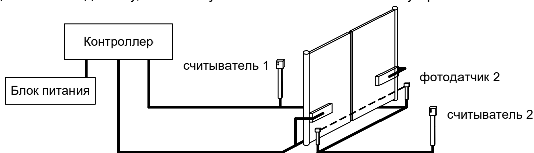
Рисунок 29. Пример автоматизации ворот с использованием карточек или меток.
